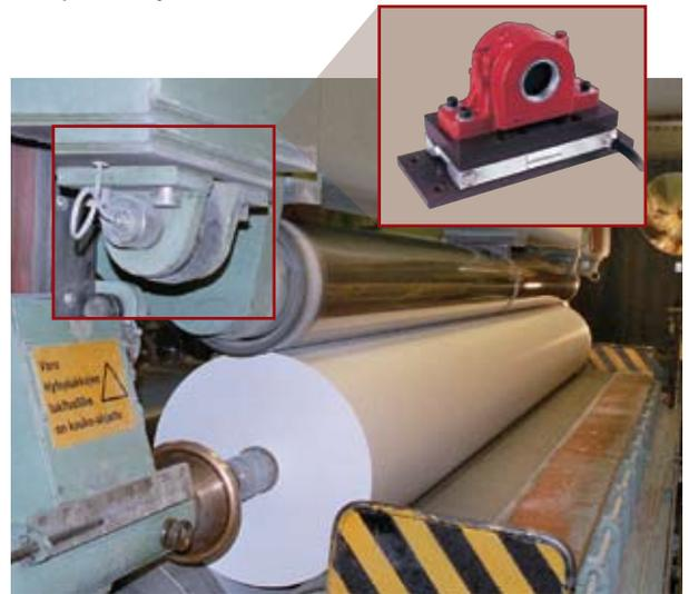
Células de carga montadas en rodillo pisón
