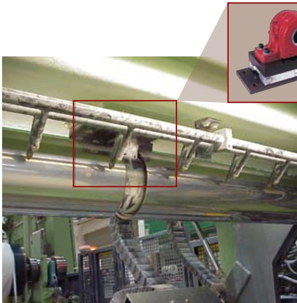
Células de carga en los soportes con rodamiento
